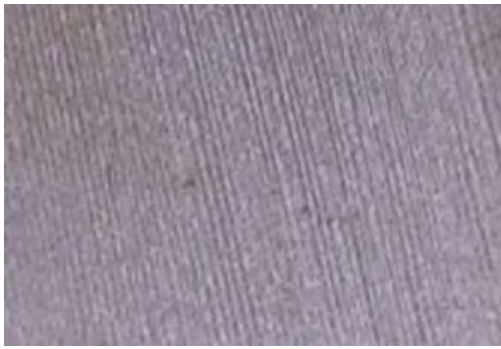
図3 流下するアルコールで観察される、筋状の対流パターン（筋は流れの方向と一致）
