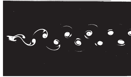
図3 円柱後流の渦列写真(カルマン渦列)。
