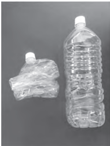
図2 2 lの空のペットボトル（右）と吸引でつぶれたペットボトル（左）。
