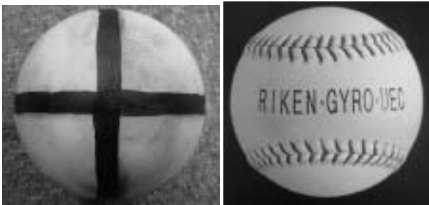
図3 試験球(左):真球,(右):硬式野球ボール
