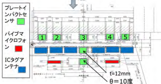
図 8 プレート型インパクトセンサーの配置
