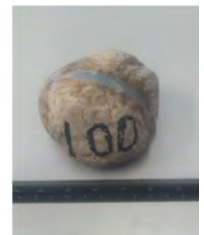
図 10 IC タグを挿入した礫 (直径 100mm)
