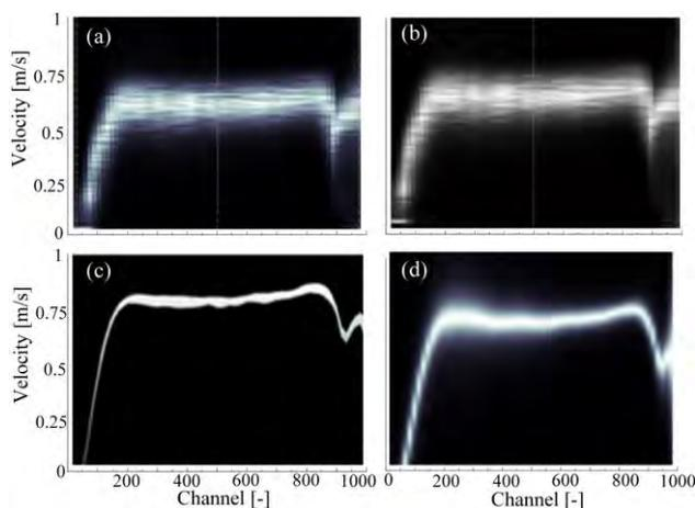
Fig. 5 Velocity estimation using (a) FFT, (b) Real-Time FFT, (c) time-domain and (d) spectral algorithms.
