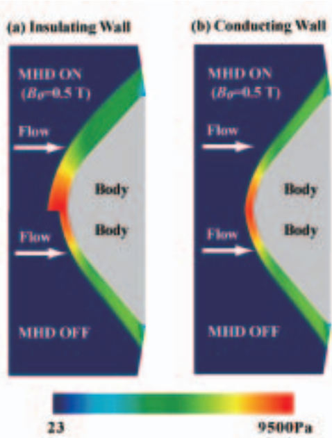
図3 磁場を印加した場合 (MHD ON) と印加しない場合の(MHD OFF)の圧力分布の比較 ((a): 完全絶縁壁条件, (b):完全導体壁条件)
