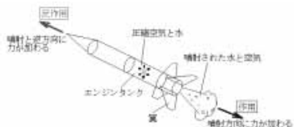
図1 ペットボトルロケットの構成と推進力に関する概念図
