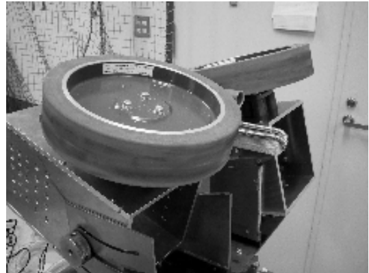
図10 Pitching Machine1 (ミズノ製、品番：2MA-676を改良したもの)
